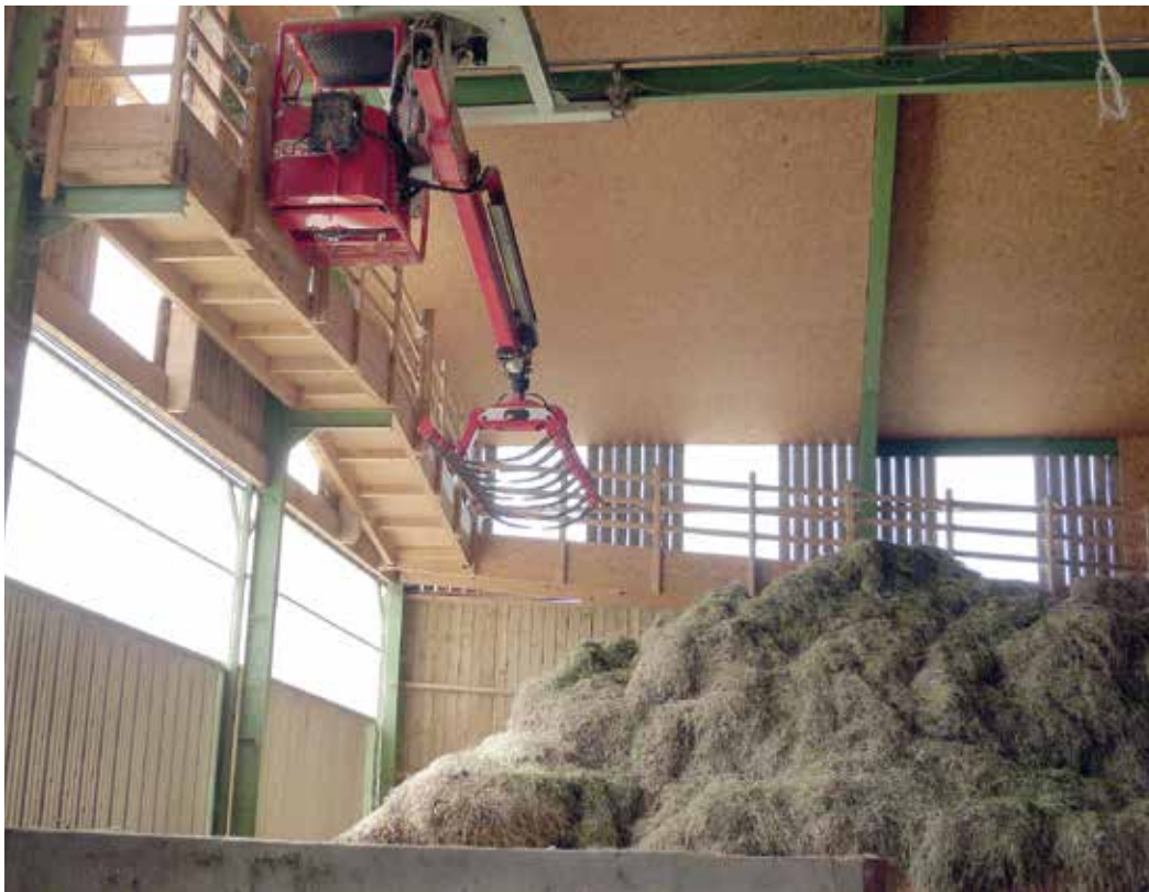
> Dispositif de séchage en grange chez un éleveur de chèvres de Pays de la Loire.
